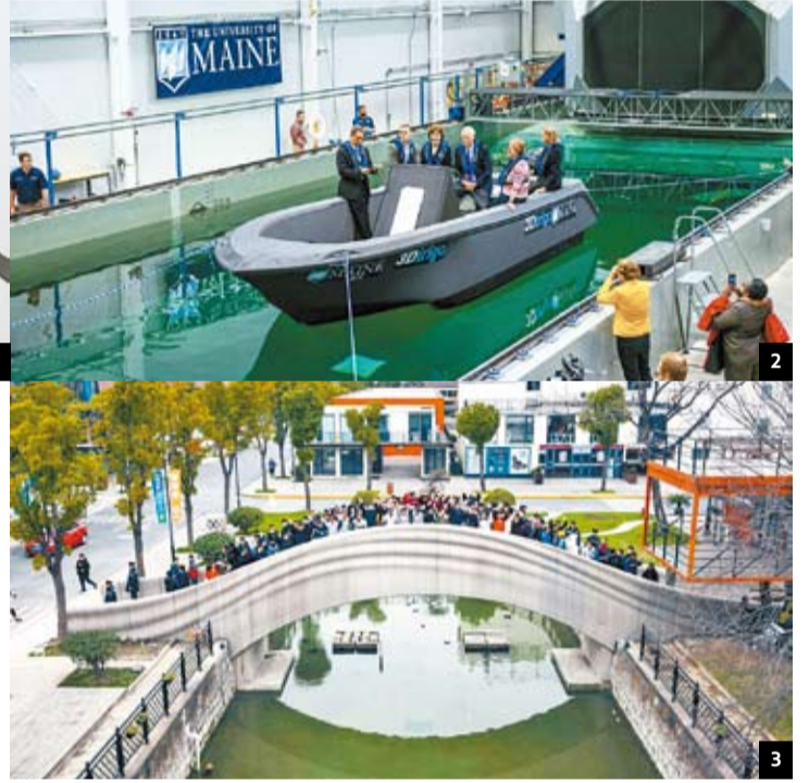
1 미국 렐러티비티 스페이스가 3D 프린터로 만들고 있는 우주로켓. 2021년 발사할 예정이다. 2 미국 메인대가 3D 프린터로 만든 경비정. 오크리지 국립연구소와 길이 8m의 선박을 72시간 만에 인쇄했다. 3 중국 칭화대 연구진이 3D 프린터로 찍어낸 26m 길이의 콘크리트 다리.
