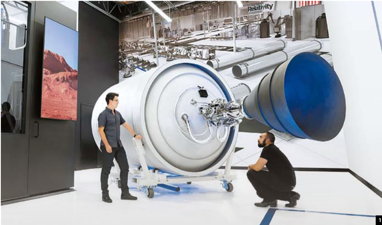
1 미국 렐러티비티 스페이스가 3D 프린터로 만들고 있는 우주로켓. 2021년 발사할 예정이다. 2 미국 메인대가 3D 프린터로 만든 경비정. 오크리지 국립연구소와 길이 8m의 선박을 72시간 만에 인쇄했다. 3 중국 칭화대 연구진이 3D 프린터로 찍어낸 26m 길이의 콘크리트 다리.
